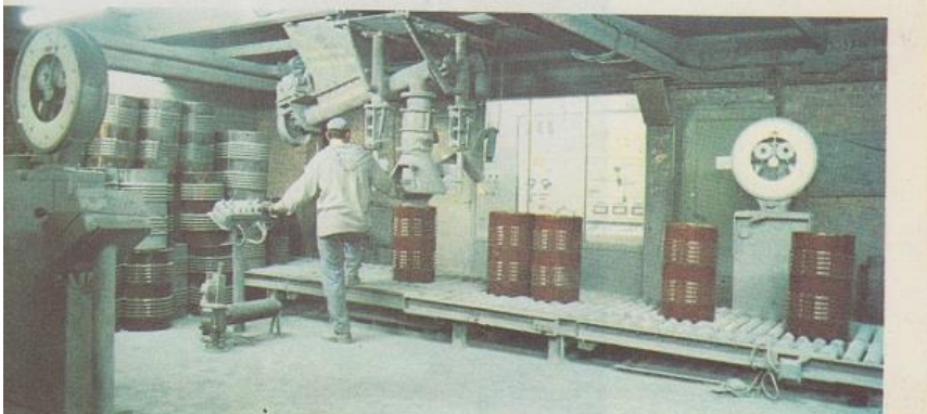
Automatische installatie voor het meten, de controle en het in vaten brengen, van zinkpoeder.
