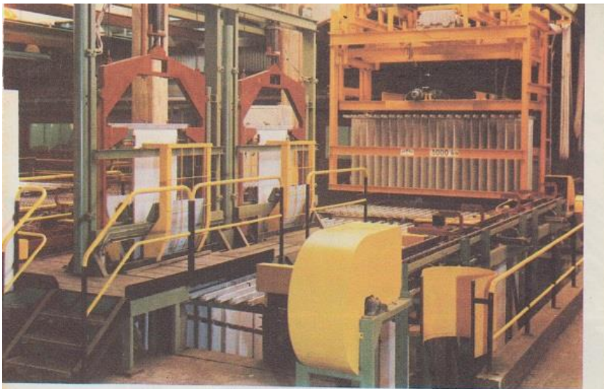
Installatie voor het mechanisch afpellen van grote zinkkathoden (« Vieille-Montagne » procédé).
